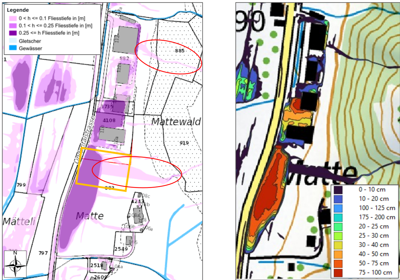
Abbildung 12: Links: Gefährdungskarte Oberflächenabfluss auf der Parzelle mit Hauptabflussquellen rot markiert und dem Projektperimeter orange umrandet. Rechts: Detaillierte Fließstiefenkarte Oberflächenabfluss [8]
